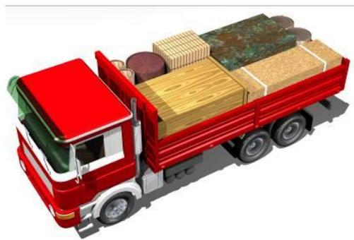
Blockieren der Ladung durch Anlegen gegen Stirn-, Seiten- und Rückwände, Rungen, Paletten, Keile, Coilmulden, Stausäcke, etc.
