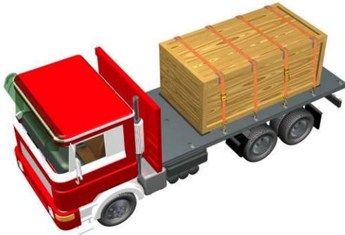
Erhöhung der Reibkraft durch Niederzurren.
