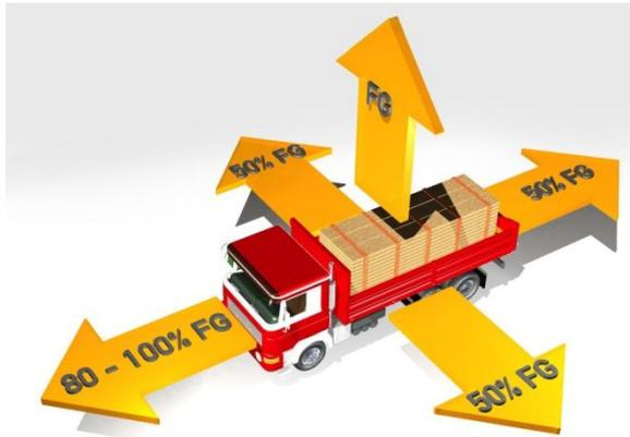
Bei Bodenunebenheiten wirken Vertikalkräfte, die die Ladung zum Abheben bringen.
