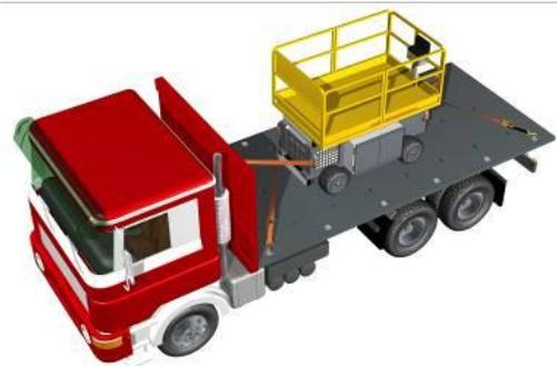
Blockieren der Ladung durch Direktzurrverfahren wie Schräg- und Diagonalzurren.
